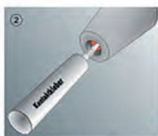
2) Einbringen des Klebstoffs in die Gewindehülse
