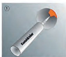
1) Einbringen des Klebstoffs in die konische Öffnung
